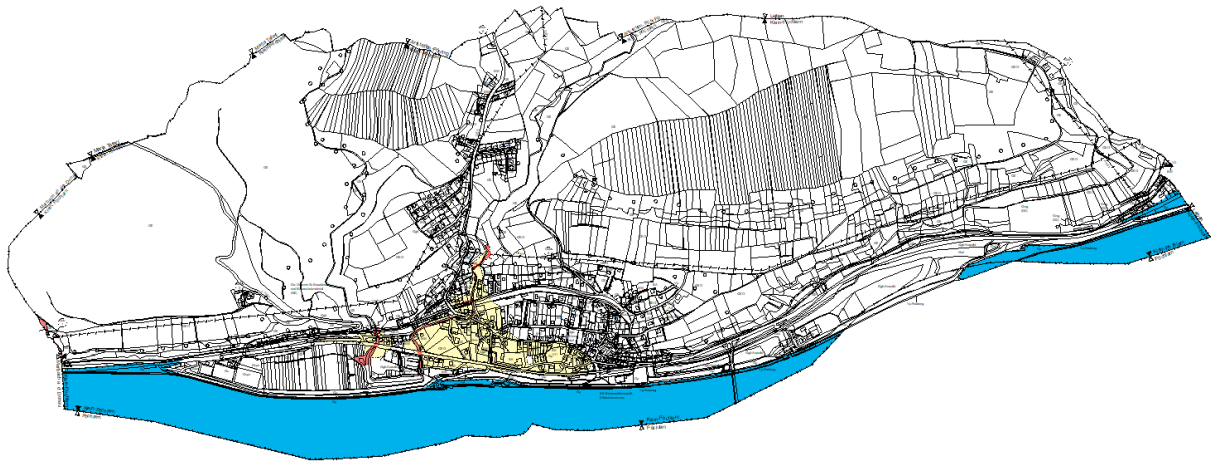
Abbildung 4: Darstellung der Gefahrenzonen und HQ100-Zone (gelbe und rote Bereich: Gefahrenzonen – Wildbach, blaue Bereiche: Donau und HQ-100-Bereich).
