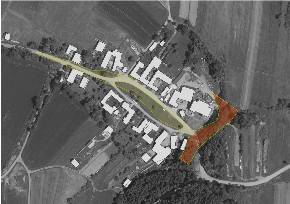
Abbildung 40: Ausschnitt aus dem Gefahrenzonenplan (Rote und Gelbe Zonen) – KG Kleinenzersdorf, eigene Darstellung 2024
