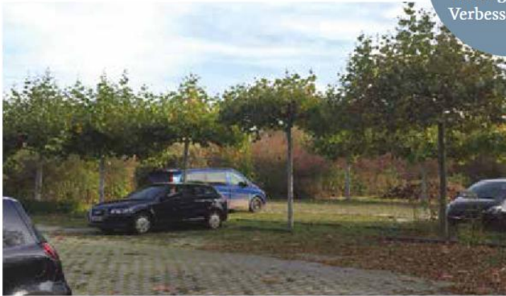
Beschatteter, versickerungsfähiger Parkplatz zur Verbesserung der Temperaturverhältnisse
