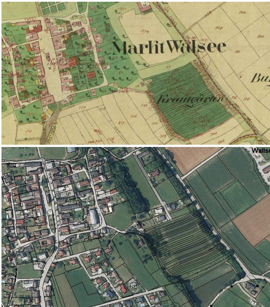
Abbildung 7: Gegenüberstellung franziszeischer Kataster <-> aktuelles Orthophoto mit Grundstücksstruktur.
