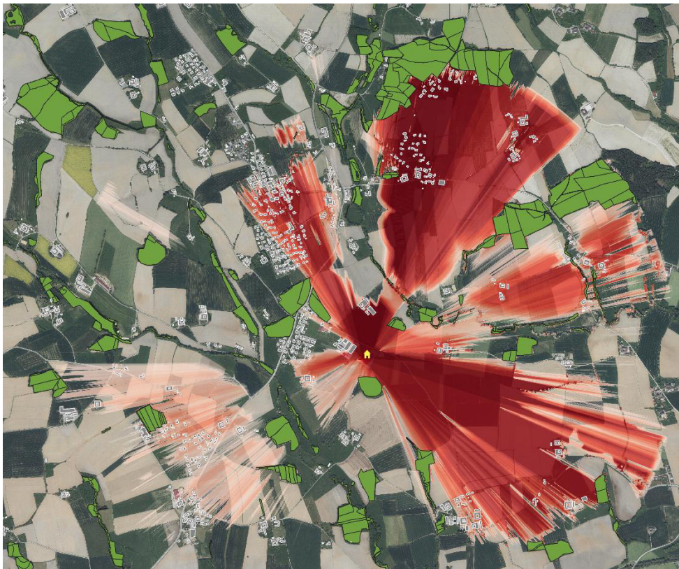
Abbildung 7: Sichtbarkeitsanalyse der geplanten Gebäudehöhe von 14 Meter
